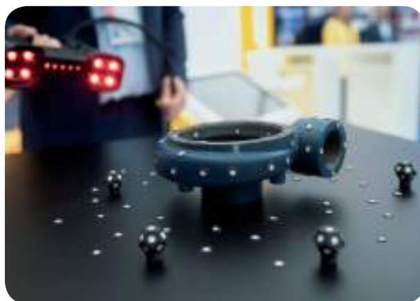
«Роснефть» использует 3D-сканирование для производства востребованных запасных частей
